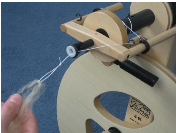
Führen Sie einen Anfangsfaden durch das Eingabeloch, über das Häkchen und durch den Fadenführschieber. Machen Sie einen doppelten Knoten am Fadenende und stecken Sie diesen in den Schlitz des Spulenschafts. Schieben Sie den Fadenführer an eine Stelle, wo dieser den Faden in die Richtung zieht, wobei der Knoten in dem Schlitz feststecken bleibt.
