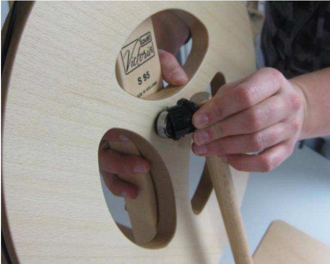
Klicken Sie die Trittstange mit der Kappe auf das Kugellager am Schwungrad und schieben Sie den Ring zum Rand. Wenn Sie die Trittstange etwas drehen, damit die Kappe etwas schräg ist, geht die Kappe leichter auf das Kugellager. Auch um sie wieder zu lockern, nachdem man den Ring zurück geschoben hat, geht es leicht, die Kappe abzunehmen, indem man die Trittstange etwas dreht.
