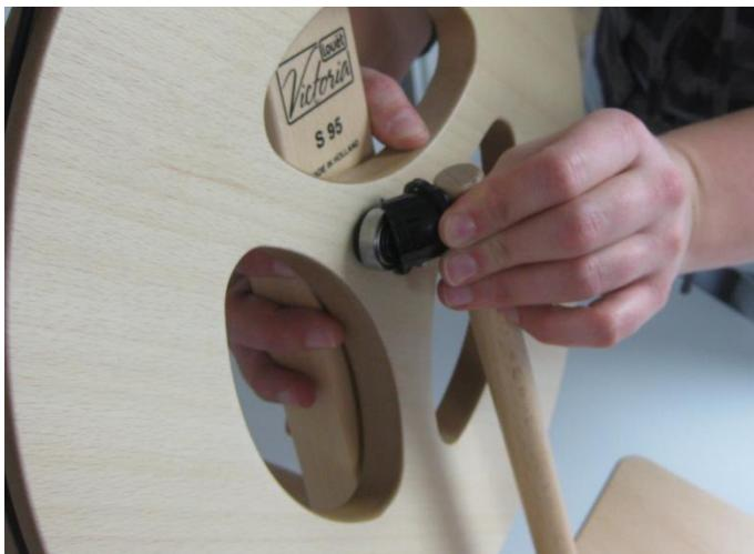
Klik de cup van het trapstokje op het kogellager van het wiel en schuif de ring naar de rand om de verbinding te zekeren. Als je het trapstokje iets draait, zodat je de cup scheef op het kogellager drukt, gaat hij er gemakkelijker op. Ook bij het weer losmaken van de cup, nadat je de ring teruggeschoven hebt, is het trapstokje draaien terwijl je trekt, de goede methode.
