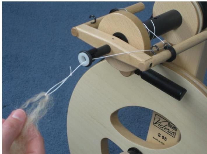
Leid een begindraad door het spingat, langs het haakje en door de verschuifbare draadgeleider. Maak een dubbele knoop aan het uiterste eind van de draad en steek die in het sleufje van de spoelschacht. Schuif de draadgeleider naar een plek waar hij de draad in het sleufje trekt. Knoop een lus in het andere eind van de draad, steek er wat vezels door van het materiaal dat je gaat spinnen en twist die aan beide kanten van de lus tot een draad.
