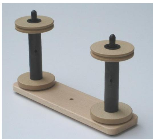
In der Mitte der Spulenhalterung für das Zwirnen ist ein drittes Loch für eine Achse für eine dritte Spule, welche man extra bestellen kann.
