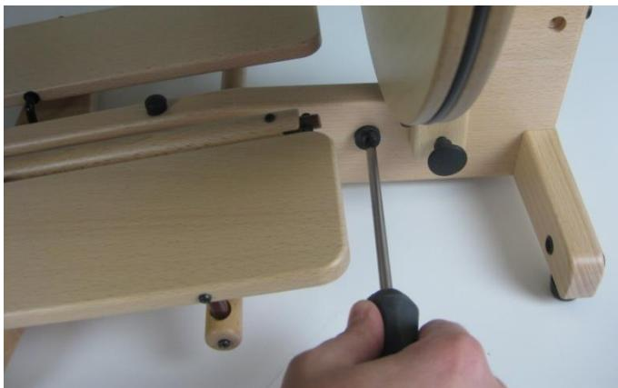
Mocht er speling ontstaan in de blokkering van de achterpaal, dan kan dat verholpen worden door het ronde buffertje, waar de paal vanonder tegen aan stuit, te verstellen. Draai het schroefje los. Verdraai het buffertje zo, dat het de paal vastdrukt en draai het schroefje weer vast.
