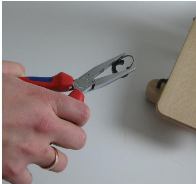
Sollte der Fadenführschieber sich zu leicht verschieben, dann können Sie ihn mit einer Zange enger machen, indem Sie das Metallbügelchen etwas zusammen drücken.
