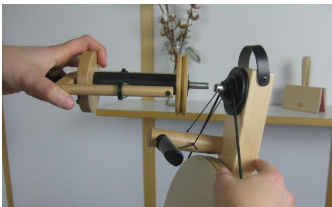
vlucht niet meer t.o.v. de poelie kan draaien. Zit de vlucht nog niet vast, draai hem dan tot de pen in de sleuf valt. De vluchtas wordt door een magneetje op zijn plaats gehouden.
